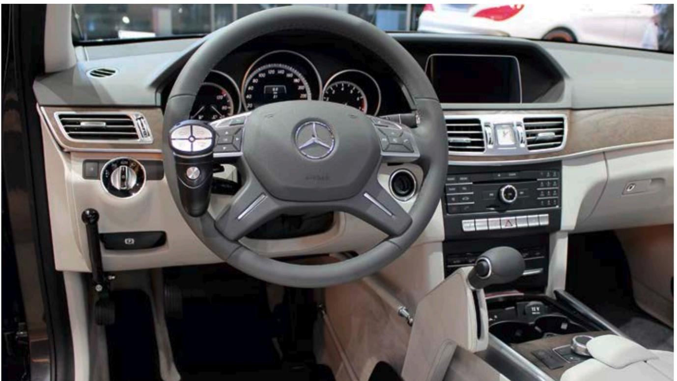
Fahrhilfen: Lenkraddrehknopf „MFD Touch“ und Handbediengerät „Easy Speed“ machen diese E-Klasse besonders leicht bedienbar
